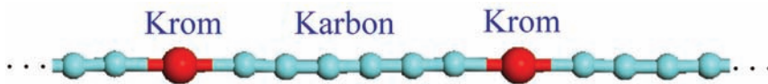
Şekil 6: Karbon ve krom (veya kobalt) atomlarının periyodik olarak dizilişleriyle oluşturulan atom zincirleri "yarım metal" özelliği göstermektedir.
